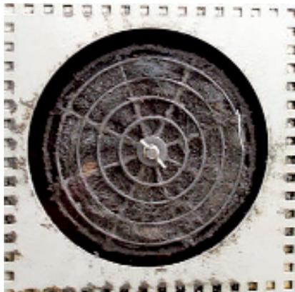
L'atmosfera oleosa e gli agenti inquinanti presenti all'interno delle officine, possono causare gravi danni ai pannelli elettrici di controllo delle macchine utensili; come mostra l'immagine qui in alto, un ventola di aspirazione d'aria può venire facilmente ostruita da una mistura di polveri e nebbie oleose.
